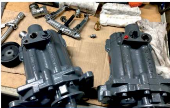
ООО «Агат», замена винтового блока
