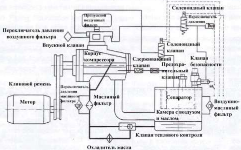
Схема технологического процесса (30 кВт)
